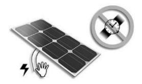
◇ 电气安装工作只能使用合格的绝缘工具。
