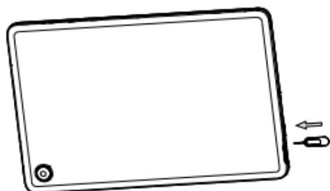
Inserte el clip de la SIM en el orificio fuera de la bandeja de la tarjeta SIM y deslícela hacia afuera con cuidado.
