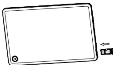
Coloque o extraiga la tarjeta SIM nano y la microSD™ en la ranura correcta tal como se indica.
