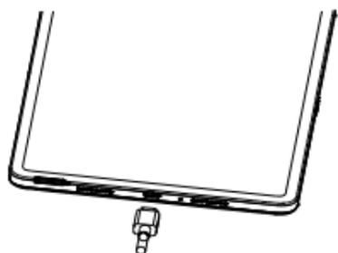
1. Inserte el cable USB tipo C en el puerto de carga, como se muestra.
